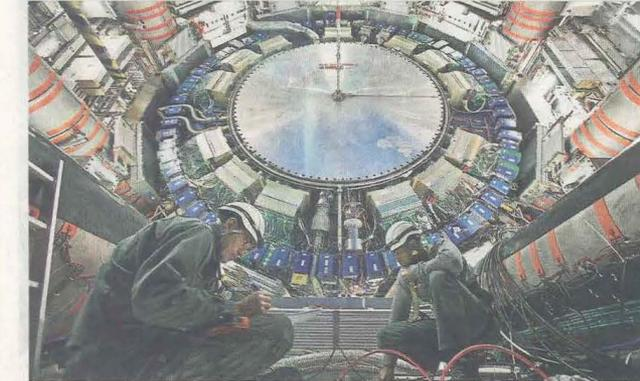
Mit einem Durchmesser von 25 Metern und einer Länge von 46 Metern ist der Atlas-Detektor das größte Nachweisgerät am Beschleuniger LHC bei Genf.
