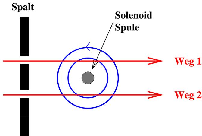
Durch ändern des Spulenstroms kann man die Phasendifferenz und damit das Interferenzmuster kontinuierlich verändern.
