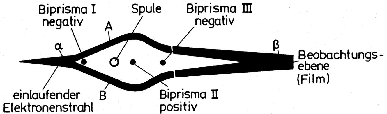
Der Elektronenstrahl wird durch einen metallisierten Quarzfaden, der sich auf negativem Potential befindet, in zwei kohärente Teilstrahlen aufgespaltet. Hinter dem ersten Quarzfaden wird eine Solenoidspule ( $14-18 \mu\text{m}$  Durchmesser) angebracht, die aus Wolframdraht von  $4 \mu\text{m}$  Dicke gewickelt ist.
