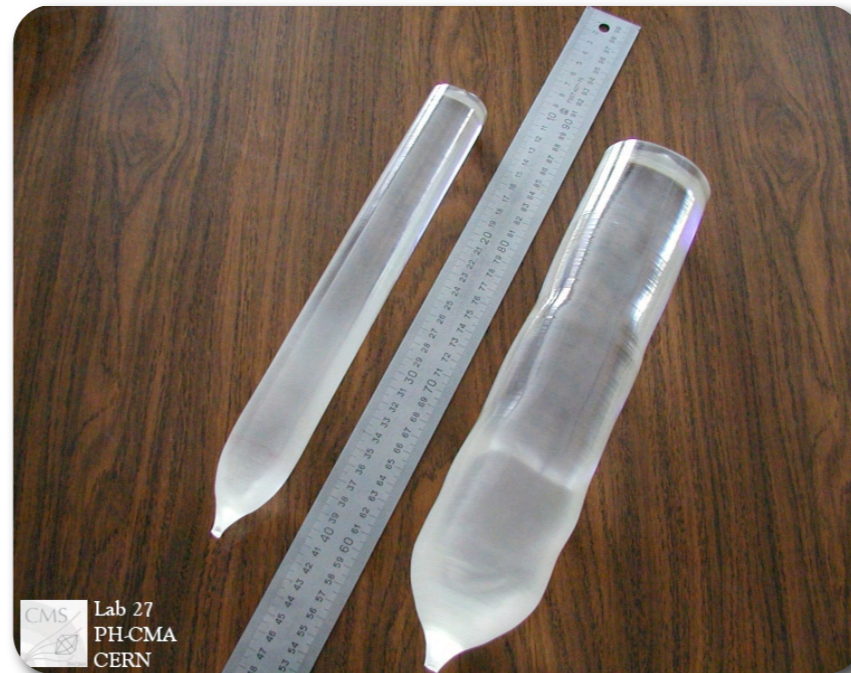
PbWO 4 : Rohmaterial für elektromagne- tisches Kalorimeter bei CMS
